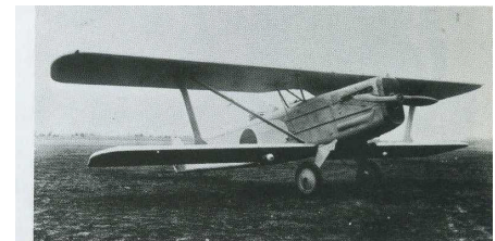
満州事変で大活躍の88偵I型 V.M.W. 500HP 機巾 15m 最大速度 200km 航続 6時間
